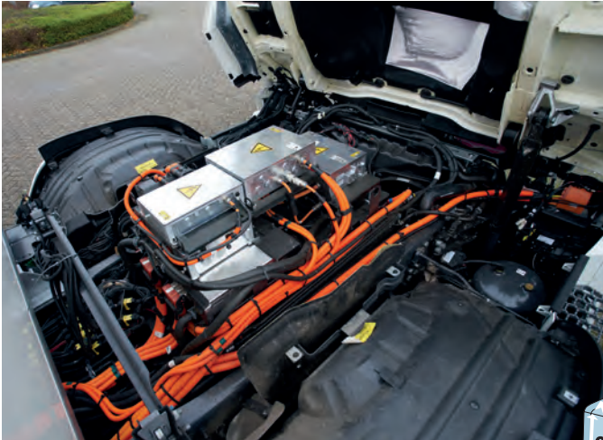
Onder de cabine bevinden zich de elektromotor en één accupakket.
