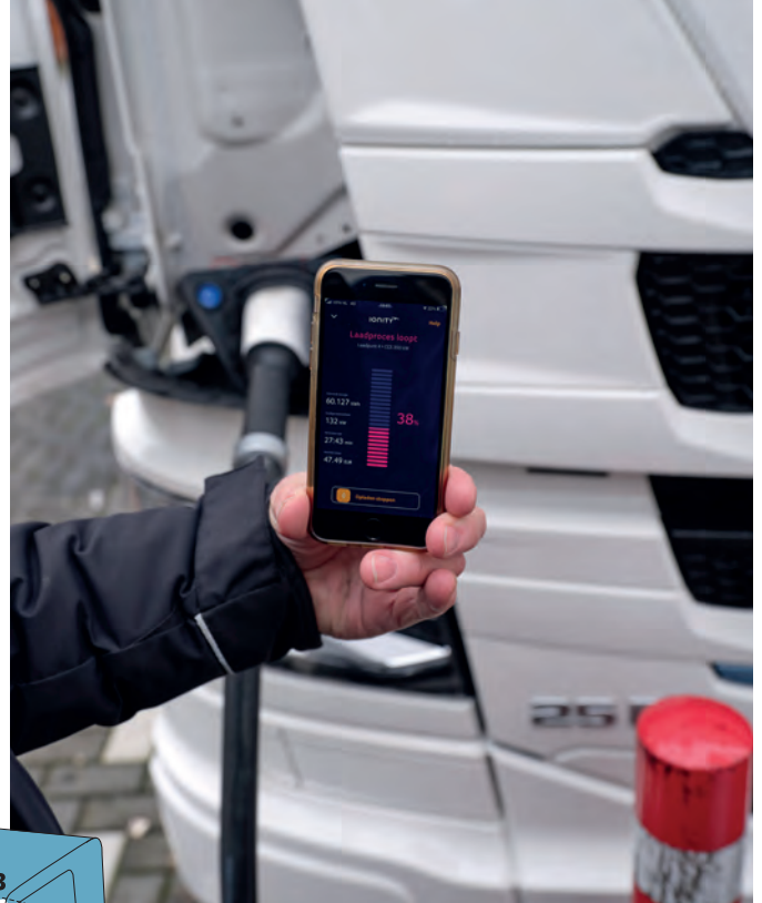
Met de truck aan de laadpaal is op de app duidelijk het laadproces te zien.
